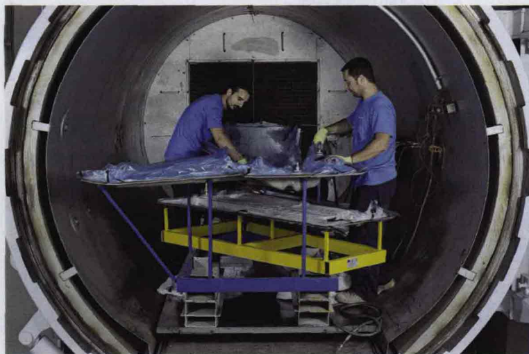
LE SINGOLE PARTI DEL VELIVOLO SOTTOPOSTE AL "CICLO DI CURA IN AUTOCLAVE"
