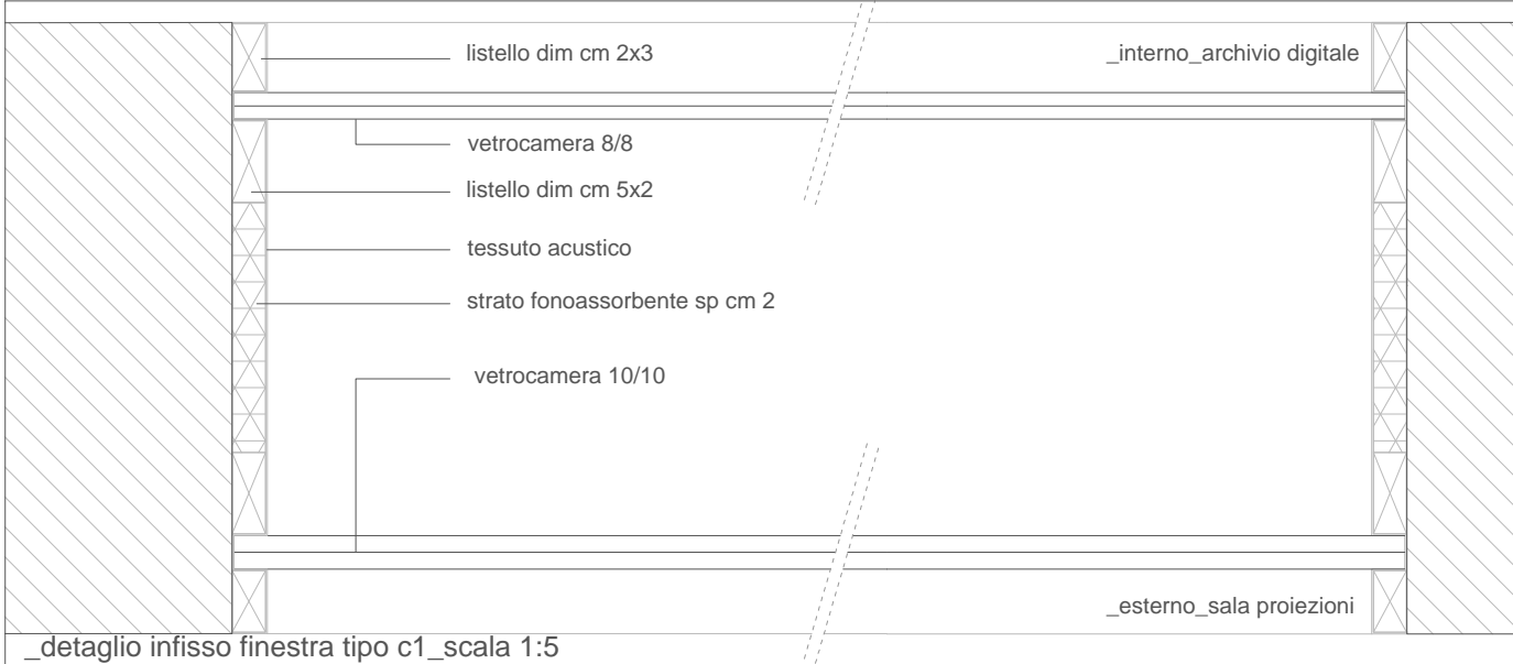
_dettaglio infisso finestra tipo c1_scala 1:5
